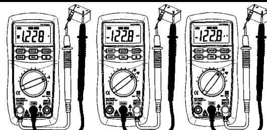
4.11.1 Вставьте штекер черного щупа в гнездо "COM", а красного в гнездо "INPUT", если измеряемый ток не будет превышать 200 мА. В противном случае вставьте штекер красного щупа в гнездо "10A".
