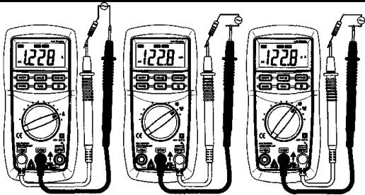
4.12.1 Вставьте штекер черного щупа в гнездо "COM", а красного в гнездо "INPUT", если измеряемый ток не будет превышать 200 мА. В противном случае вставьте штекер красного щупа в гнездо "10A".
